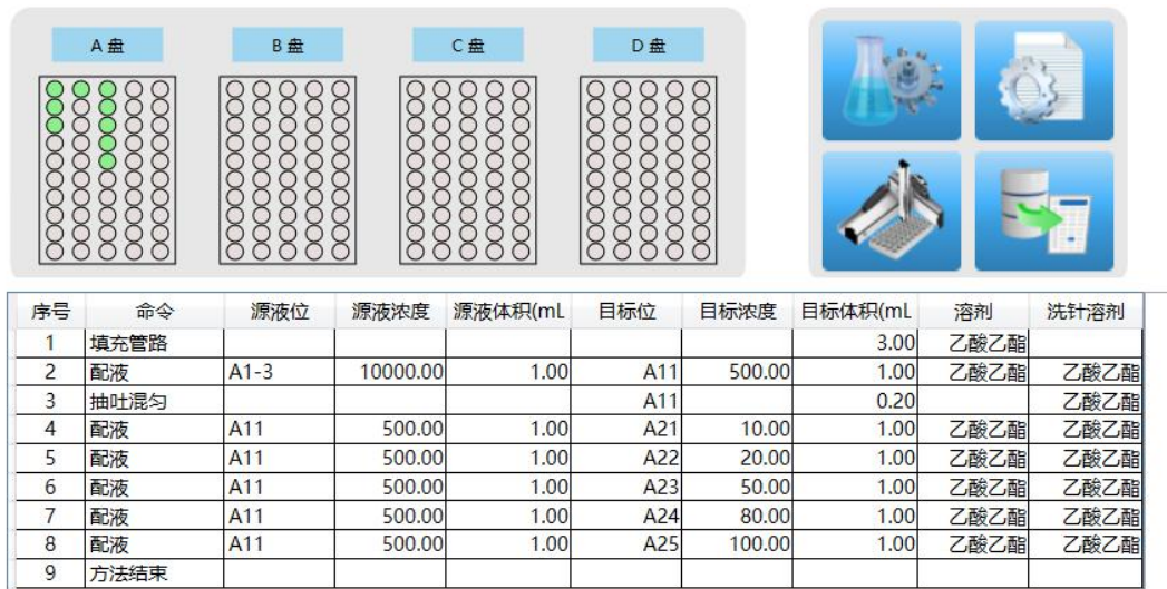
图-1 Auto Prep 200 的氯吡脉标准溶液配制方法
