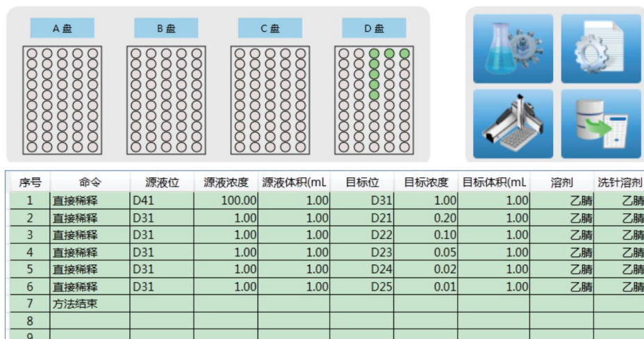
图-1 Auto Prep 200 的氯吡脒标准溶液配制方法
